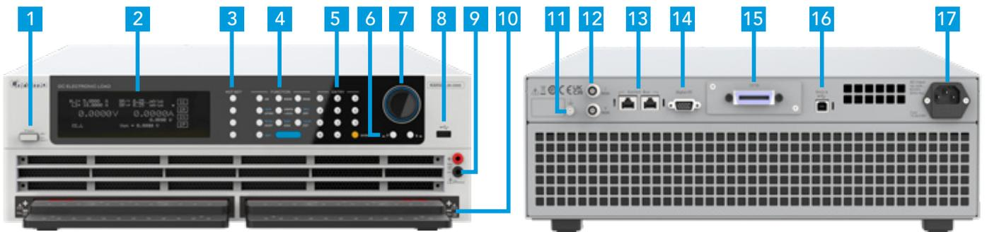
1. 电源开关: 电子负载主机的交流电源开关
